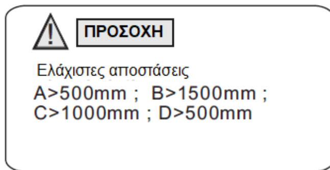
Τοποθέτηση της μονάδας για οριζόντια έξοδο αέρα
